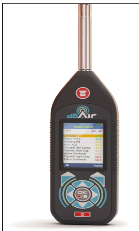
Εικόνα 7-2: Ο μετρητής θορύβου Castle dBAir Model GA 141 που χρησιμοποιήθηκε για τον σκοπό της μελέτης
